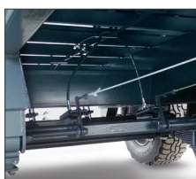
Longerons tubulaires HLE 200 x 100 ép. 8 mm (sauf SP 6006 : ép. 5 mm)
