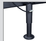
Béquille hydraulique par distributeur tracteur
