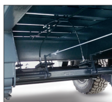
Longerons tubulaires HLE 300 x 100 ép. 8 mm
