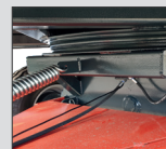
Tourelle AV oscillante fabriquée en tôle de 6 et 8 mm
