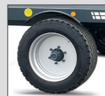
Roues encastrées pour une faible hauteur de plancher
