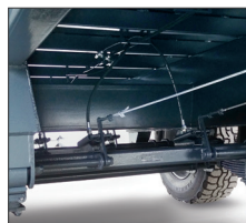
Longerons tubulaires HLE 300 x 100 ép. 8 mm Traverses sous plancher en tube de 100 x 50 x 3.2 mm
